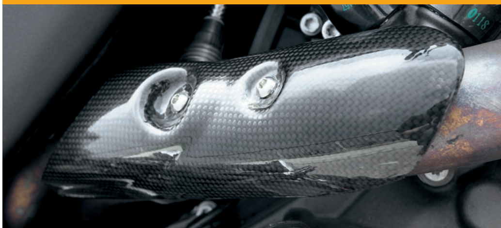
Die HPE-Auspuffanlage aus Italien besteht aus Edelstahl und besitzt eine EG-BE. Federleicht im Vergleich zum originalen Metallblech: Ilmberger Carbon-Hitzeschutz
