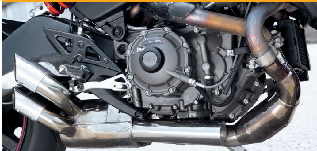
Die HPE-Auspuffanlage aus Italien besteht aus Edelstahl und besitzt eine EG-BE. Federleicht im Vergleich zum originalen Metallblech: Ilmberger Carbon-Hitzeschutz
