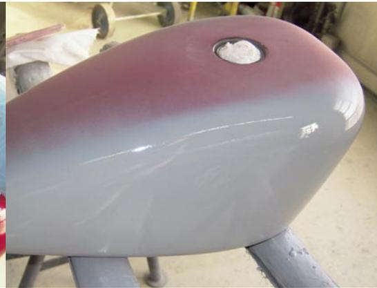
**Mühsame Vorarbeit:** Das Dekor von dem mit Originallack geschmückten Sportster-Tank muss heruntergeschliffen, gespachtelt und gefüllert werden (oben). Schwarzer Lack bildet den Untergrund (unten)
