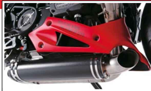
Der nach vorn ausatmende Endschalldämpfer ist leider ein Einzelstück, der LSL-Lenker modifizierte Serienware
