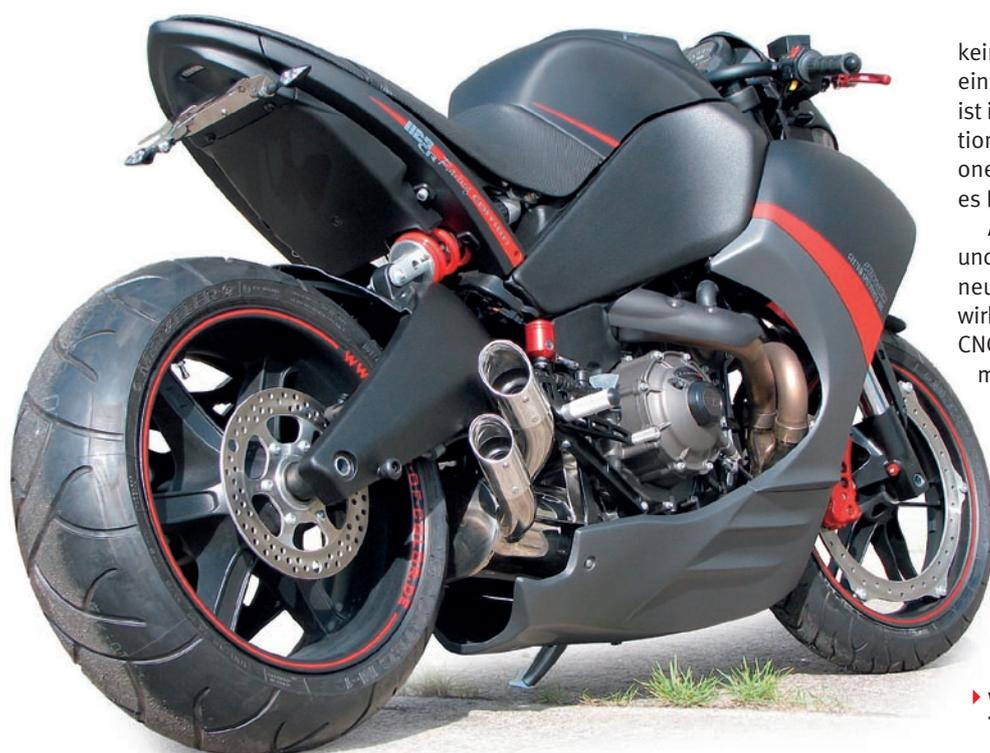
kein Rücklicht mehr vorgesehen, lediglich eine Kennzeichenbeleuchtung mittels LED ist integriert. Die Rück- und Bremslichtfunktion übernehmen beliebig wählbare All-in-one-Blinker, in diesem konkreten Fall sind es Kellermänner vom Typ „Rhombus DF“.
