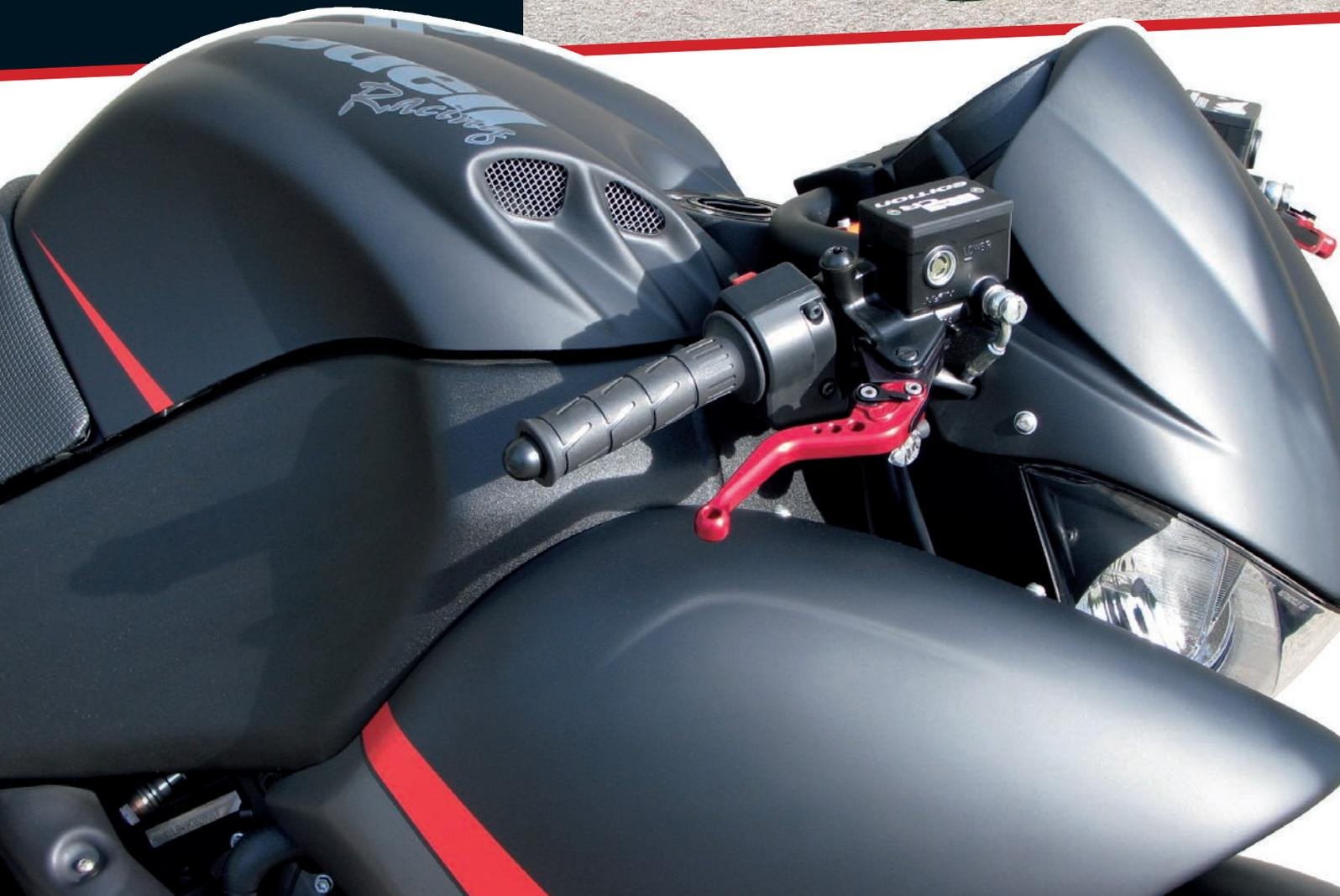
Wichtig: Die werksseitige Kühl-Konfiguration bleibt unangetastet. Die von SOC entwickelten Seitenteile werden über die originalen Wasserkühlerhutzen (Hamsterbacken) gestülpt
