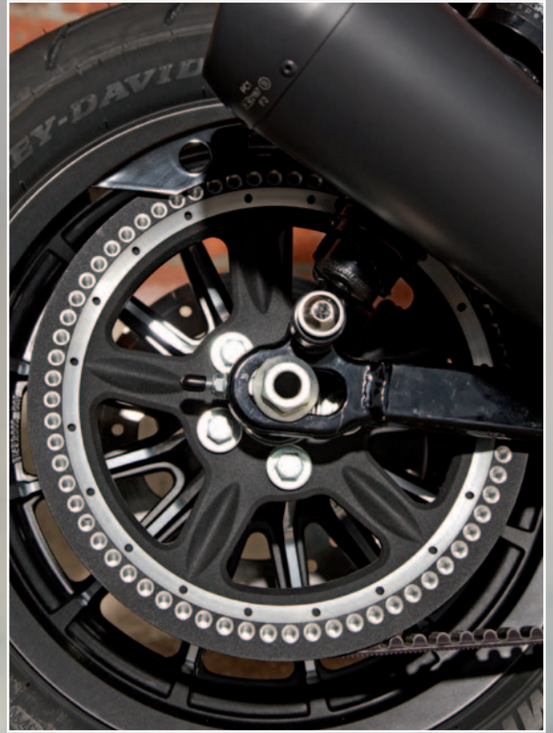
Den Tachohalter gibt's bei Roland Sands Design, die Standrohr-Cover fertigt SoC selbst (o.). Durch Zierbohrungen verschönertes Pulley (re.)
