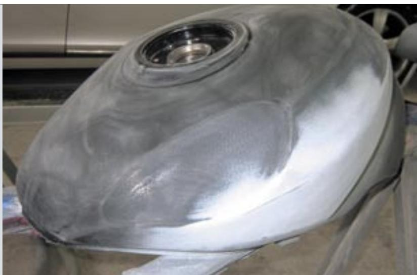
Frühschicht: Der erste Farbauftrag erfolgt mit glänzendem Füller
