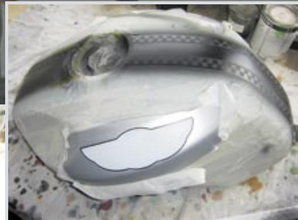
Ausgeplottete Schablonen werden präzise aufgeklebt
