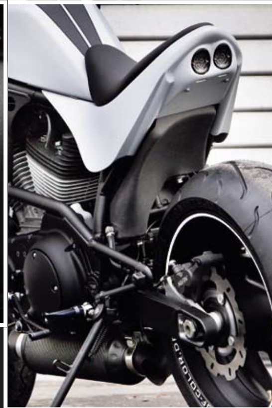
Hinter Gittern: Der Riemen dreht sich unter einer gefrästen Abdeckung (links). In das knappe Heckteil hat Speed of Color eine Doppellrückleuchte integriert (rechts)
