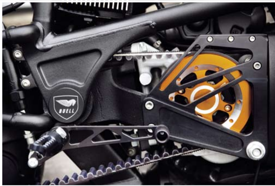
Hinter Gittern: Der Riemen dreht sich unter einer gefrästen Abdeckung (links). In das knappe Heckteil hat Speed of Color eine Doppellrückleuchte integriert (rechts)
